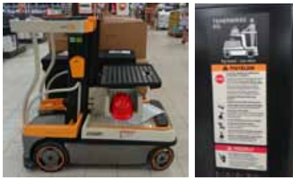
10. kép. a) Talajszintről és kismagasságról kommissiózó targonca b) Tájékoztató a targoncán
