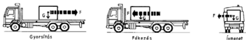
9. ábra. A tehergépkocsin elhelyezett rakományra gyorsításkor, fékezéskor, illetve kanyarodáskor ható tömegerek
