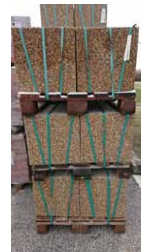
9. kép. Pántolt tárolási egységek, a raklapokon is pántolva, rakatolva
